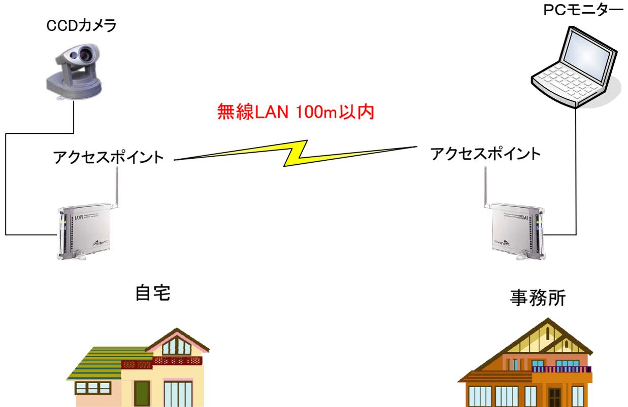
建物間を無線LANによりCCDカメラの遠隔操作を実現します。また、マイクやスピーカーを接続する事で音声相互が実現出来ます。
